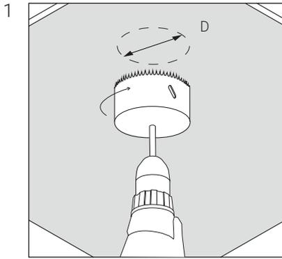
Сделайте отверстие с помощью монтажной коронки Neo 96-D90 мм.
