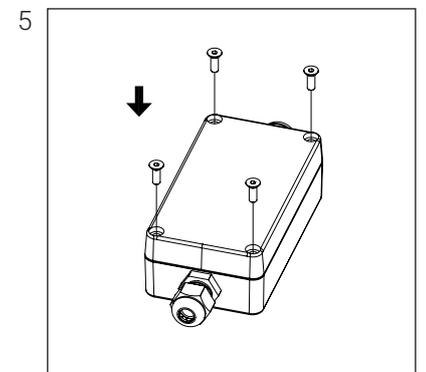
Закрепите провода и крышку блока питания.
