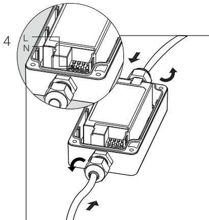
Подключите световой модуль (поз. 2) к блоку питания (поз. 4). Блок питания к электросети (см. схему подключения).
