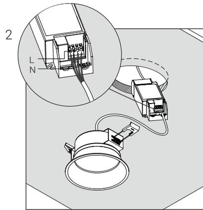
Подключите блок питания (см.схему подключения), а затем установите его за потолок.
