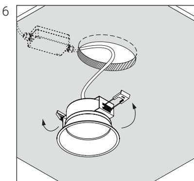
Установить светильник, предварительно отогнув зажим.
