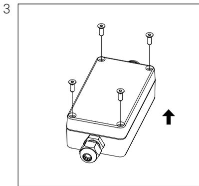
Снимите крышку блока питания.
